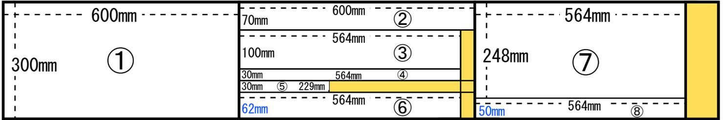
板材 : No2 パイン集合材 サイズ : 1820mm × 300mm 厚み 18mm
